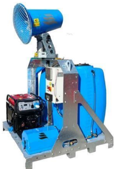
SISTEMA COMPLETO ALLESTITO SU BASE UNICA, INFORCABILE CON MULETTO O SOLLEVABILE CON GANCI
